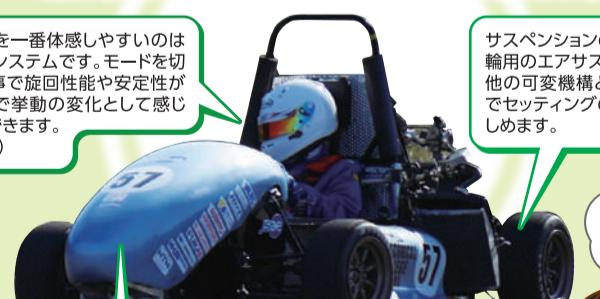
流れをイメージさせるよう曲線を多用し、可変機構などの車としての機能+αのものが多く搭載していることから、カウルは他の部品を目立たせるようにシンプルにしています。(森さん)
